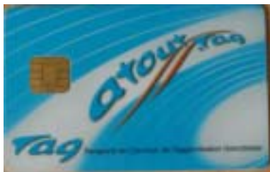
FIG. 3 – Carte à puce à double interface double des transports en commun de Grenoble
